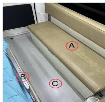
ภาพที่ 2 รพยบาลลูกฉุนขั้นสูง (ซ้าย) และสภาพภายในตู้โดยสารด้านหลัง (ขวา) โดยทำการทดลองบนพื้นผิว 3 ชนิด หนังสั้งเคราะห์ (A) สแตนเลส (B) และ ไฟเบอร์กลาส (C) ภายในตู้โดยสารด้านหลัง
