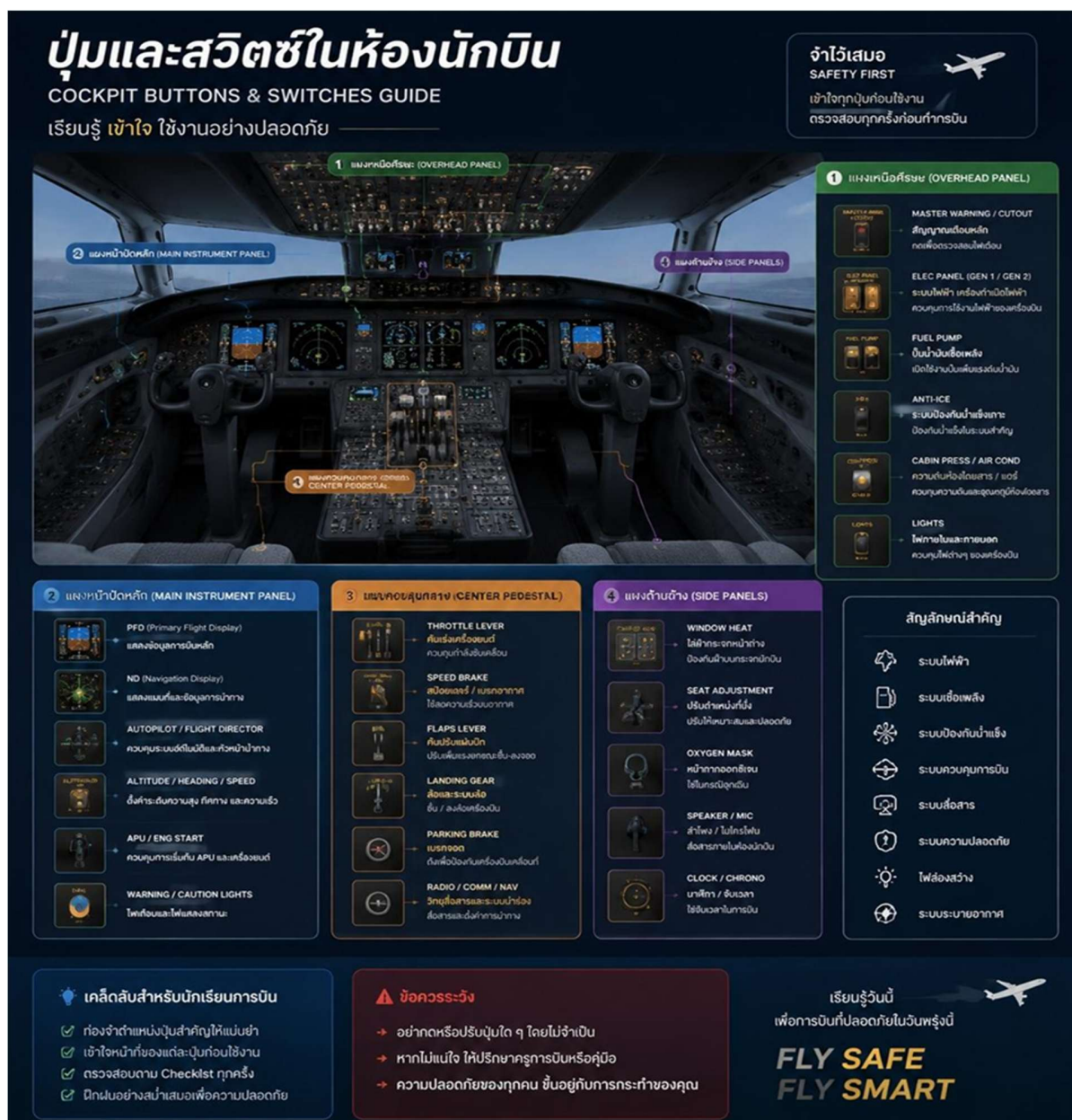
ภาพที่ 4 แบบจำลองภาพโปสเตอร์แสดงปุ่มและสวิตช์ในห้องนักบินสำหรับนักเรียนการบิน
