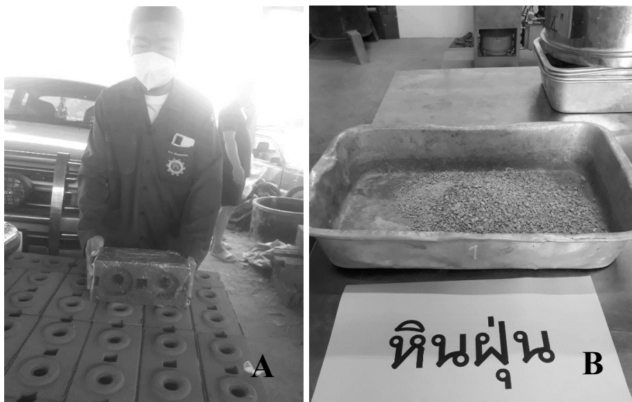
ภาพที่ 5 อัฐบล็อกประสานจากวัสดุคอนกรีตเหลือทิ้งทางการศึกษา (A), หินฝุ่น (B)
