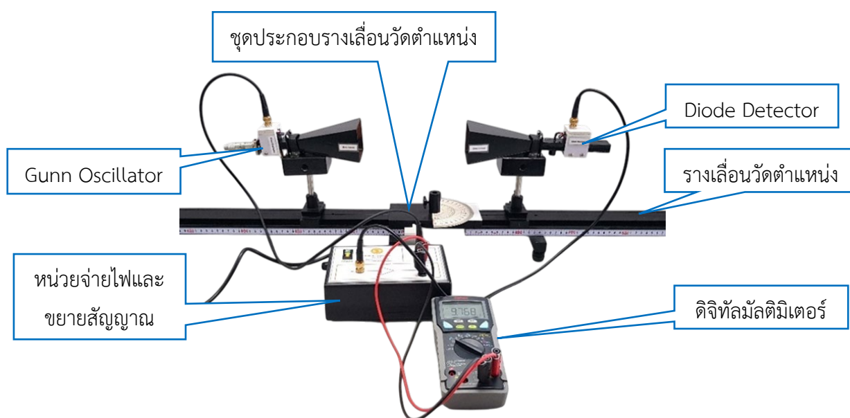
ภาพที่ 19 แสดงการจัดเครื่องมือการทดลองเพื่อหาความยาวคลื่น
