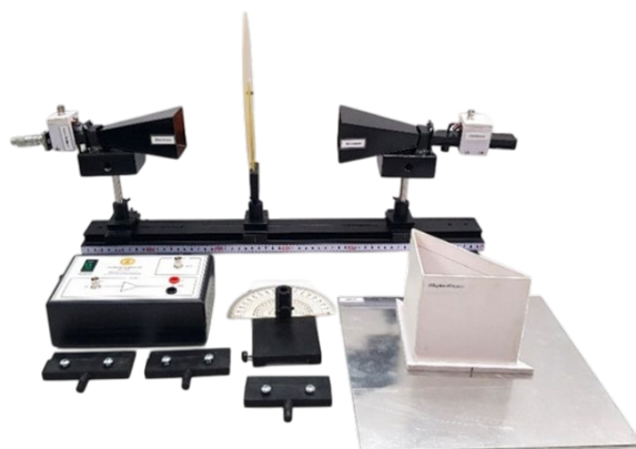
ภาพที่ 17 แสดงชุดทดลองทัศนศาสตร์ไมโครเวฟพื้นฐาน โดยวิธีวิศวกรรมย้อนรอย ที่สร้างขึ้น
